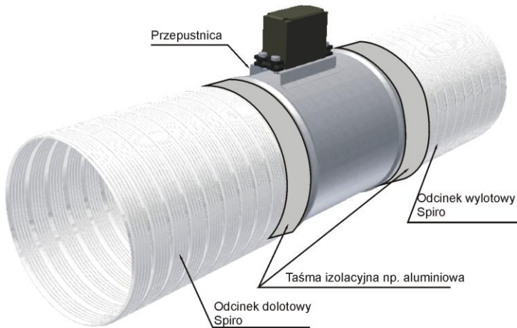
Rys. 16.8 Sposób podłączenia przepustnicy
